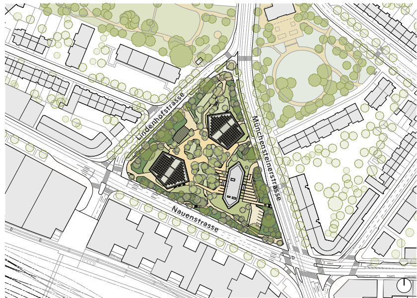
Die Lösungsmöglichkeiten waren begrenzt. Der Bebauungsplan und auch das Wettbewerbsprogramm definierten Form und Lage der Türme. Situation, Mst. 1:3500.
