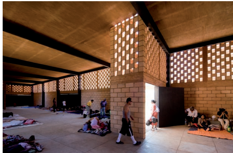
1300 M ATENGUILLO HERBERGEN Luis Aldrete entwarf die spartanischen Unterkünfte aus Lehmstein. Diffus dringt das Tageslicht durch die versetzt angeordneten Ziegel.
